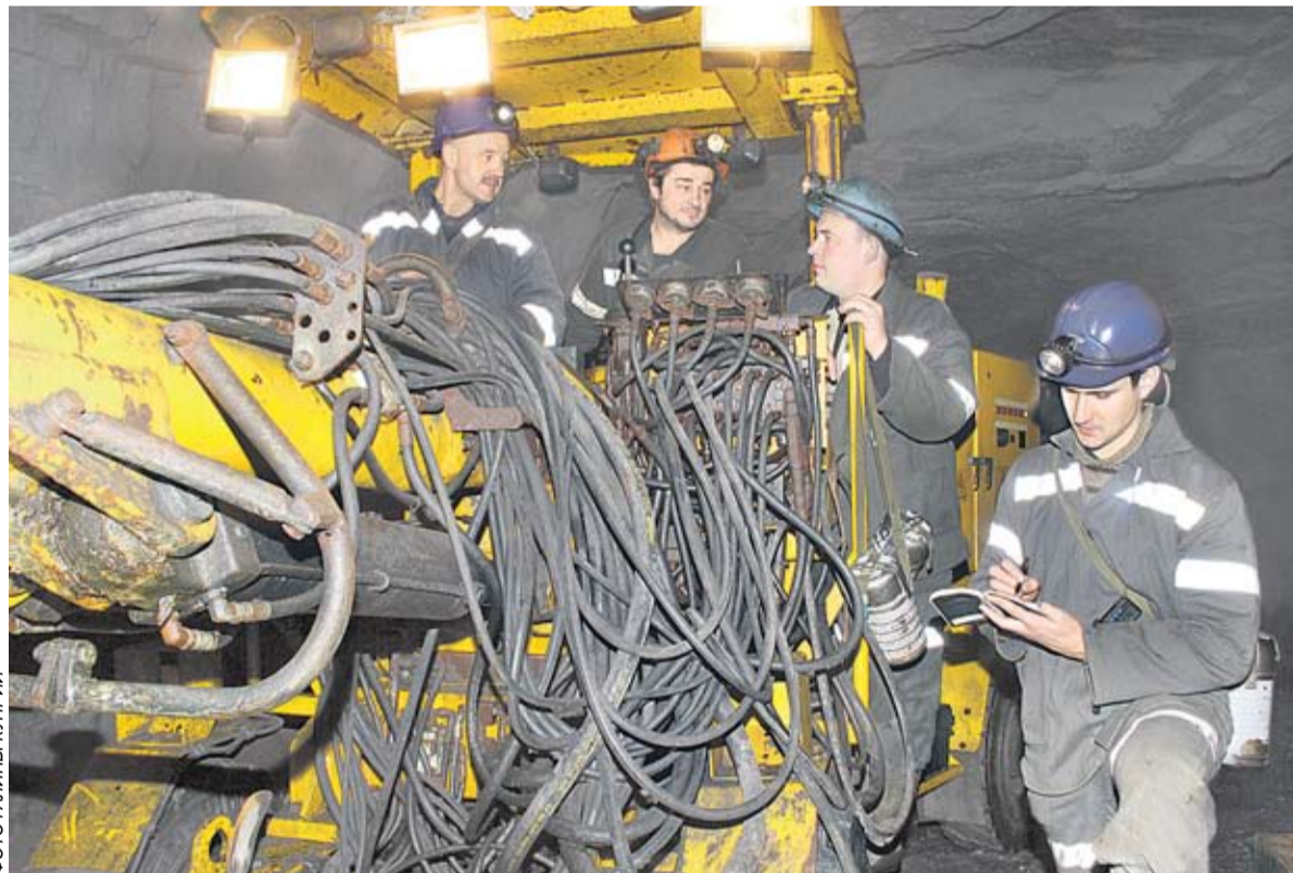
Нормировщики шахты А.Д. Каунов и Г.Р. Ракчев (по краям) проводят хронометражные наблюдения за проходческими работами
