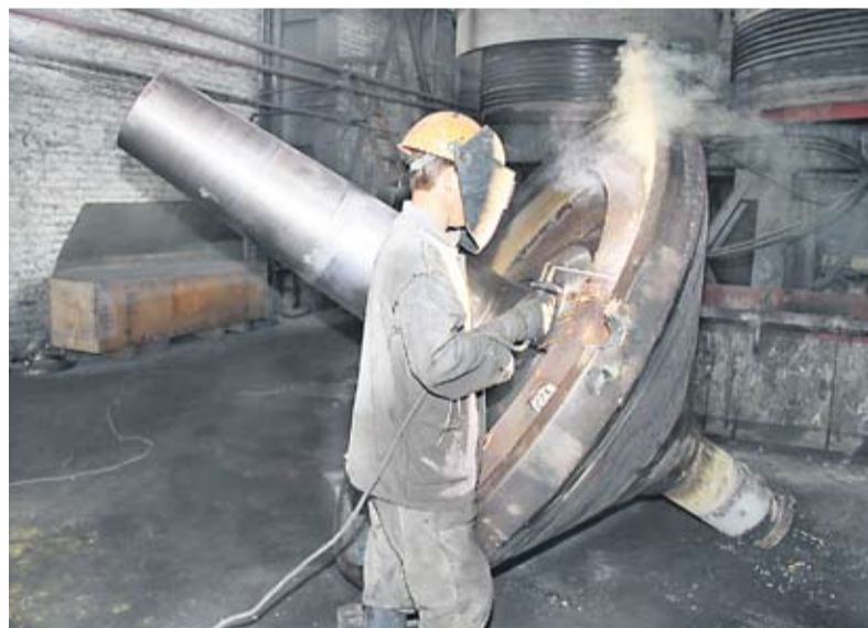
А.М. Казулин варит дробящий конус дробилки КСД-2200
